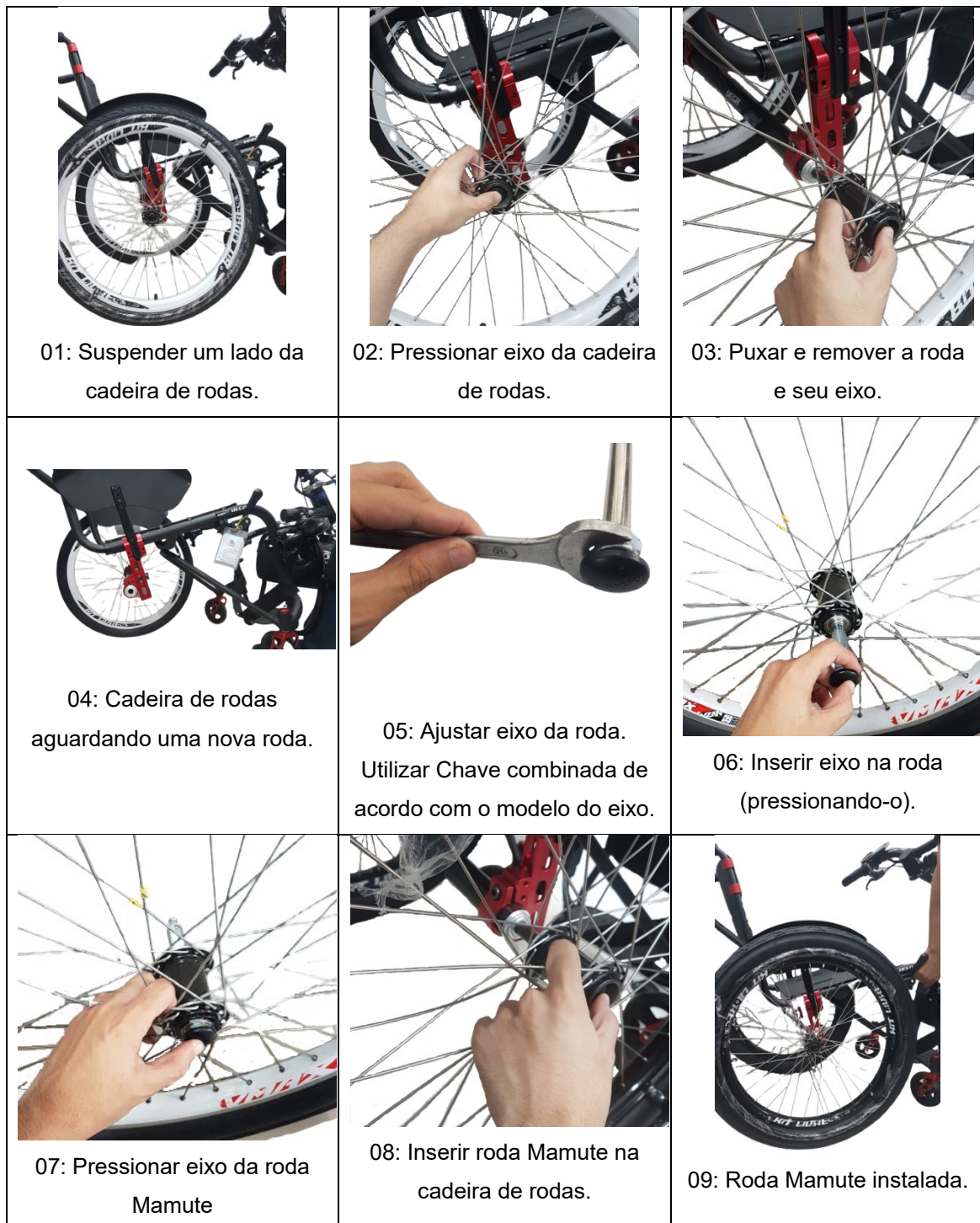
Figura 37 - Procedimento para instalação das Rodas Esportivas Mamute.
